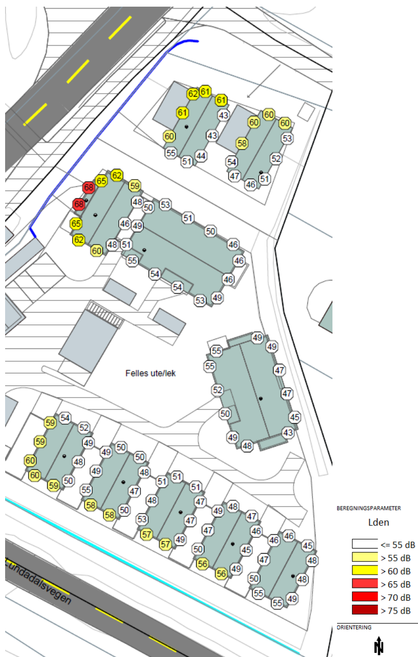
Figur 6 - Ekvivalent støynivå, L_{den} , ved fasade av ny bebyggelse. Figuren viser høyeste nivå i hvert punkt uavhengig av etasje. Utklipp fra vedlagte tegning X003.
